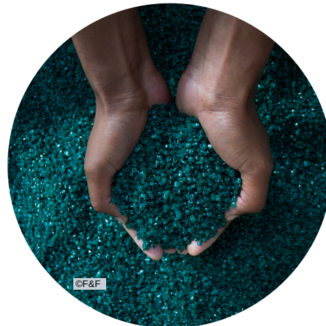
Le Nylo, matière qui résulte du recyclage des filets sous la forme de granule. Les filets sont triés par couleur pour permettre une diversité des granules.
